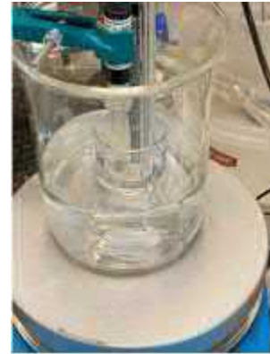
Рис. 8. Ионмер с подключённым фторид-селективным электродом и ЭСр. Ag/Cl для измерения калибровочной зависимости
